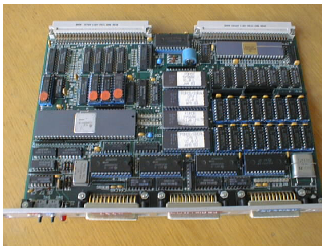
Slika 7a:16-bitno mikroracunalo realizirano s Motorola MC68000/68010 mikroprocesorom - originalna Motorolina verzija
